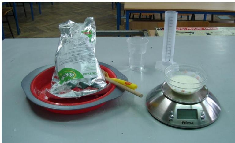
Slika 5. Pribor za pripremu vodene suspenzije kukuruznog škroba
