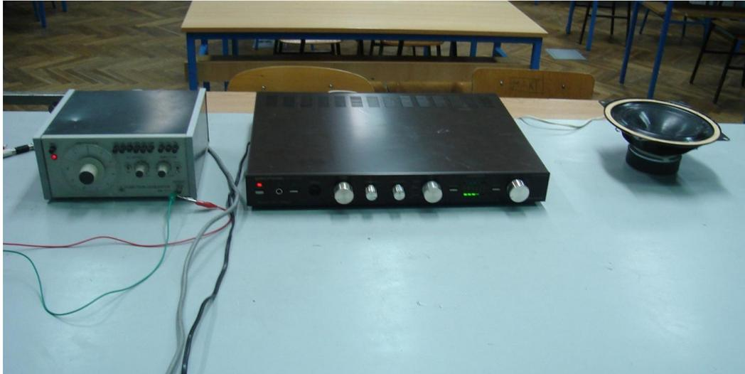
**Slika 7.** Generator frekvencija, pojačalo i glasni zvučnik spremni za eksperiment
